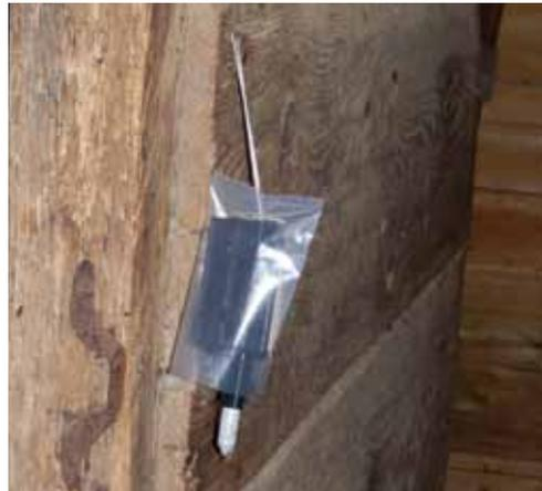
Um das Raumklima zu erfassen, wurden Klimadatenlogger installiert. Mit ihnen werden Temperatur und Luftfeuchte erfasst.
